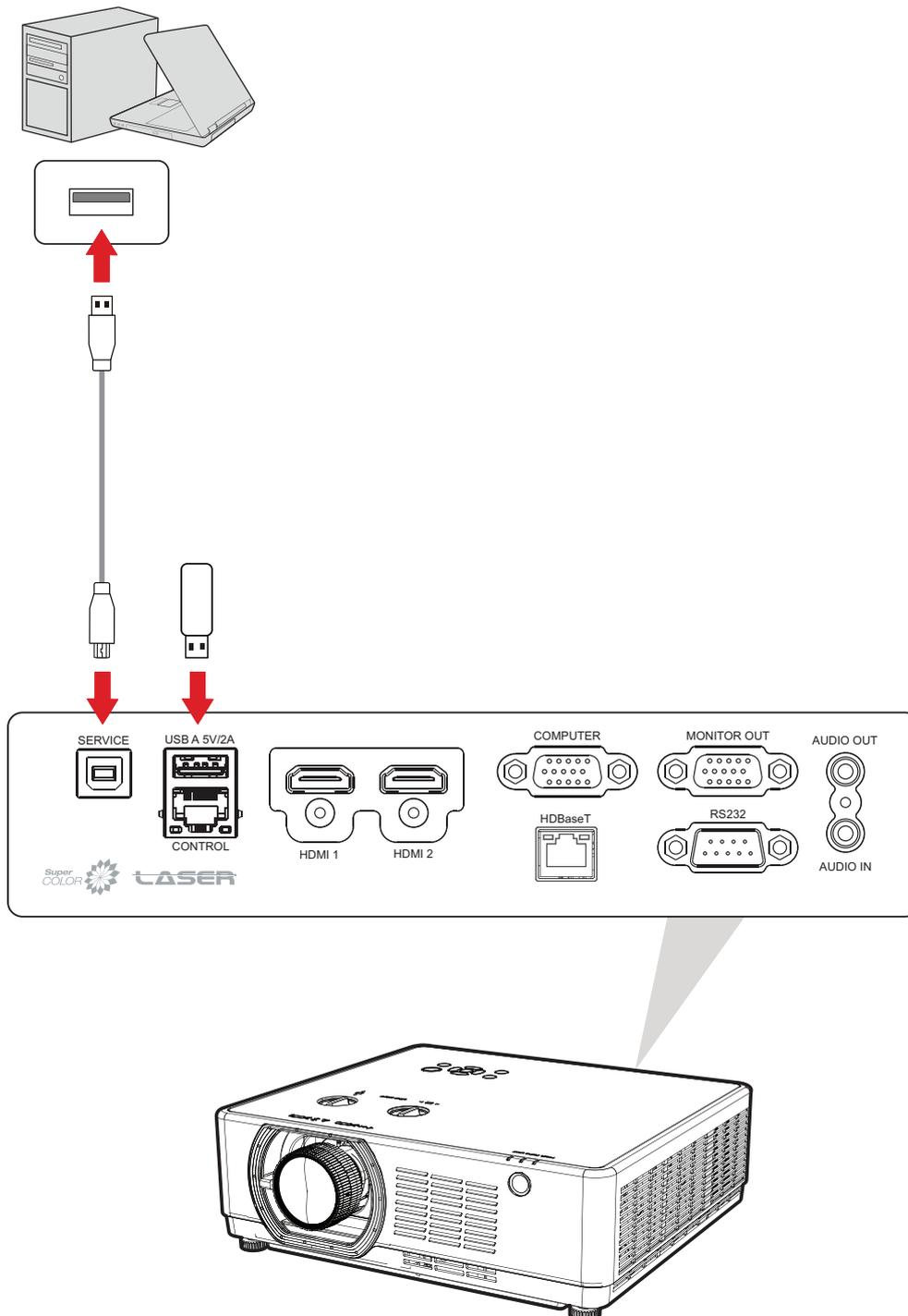
6- Der USB-Typ-A-Anschluss unterstützt das Firmware-Update für die Modelle LSC601-4K und LSC701-4K. Bitte verwenden Sie dazu die entsprechende Funktion im Menü des Projektors, **Firmware-Update per USB**.
