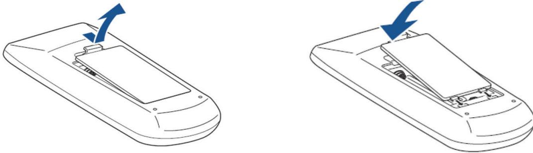
1. Entfernen Sie die Batteriefachabdeckung an der Unterseite der Fernbedienung.
