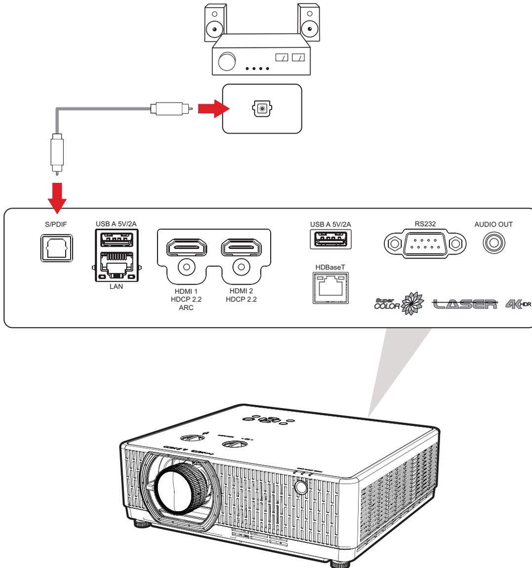
**HINWEIS:** Der Anschluss **HDMI 1** unterstützt ARC<sup>5</sup>. Er kann Ton über den Anschluss **HDMI 1** an externe Geräte liefern.
